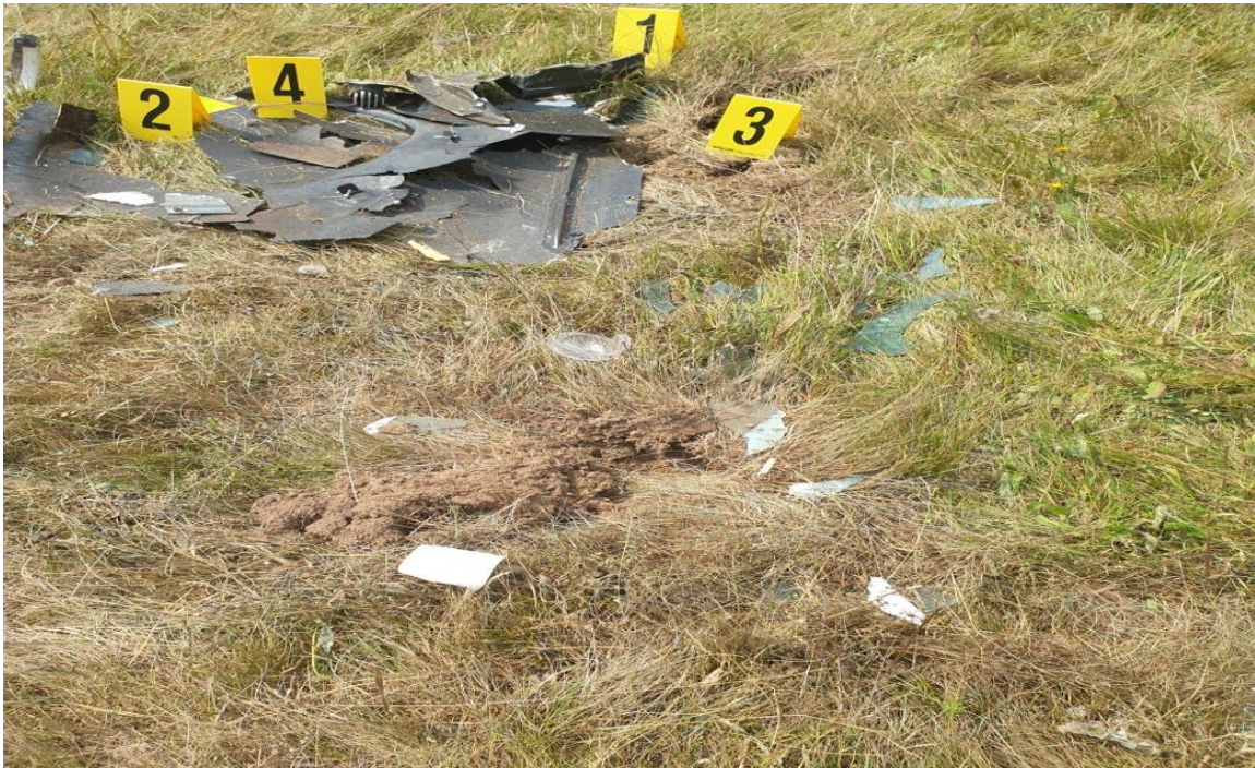
Slika broj 1.10: Prvi udar u zemlju, ostatci oplata motora, krak elise i komadi pleksi stakla
