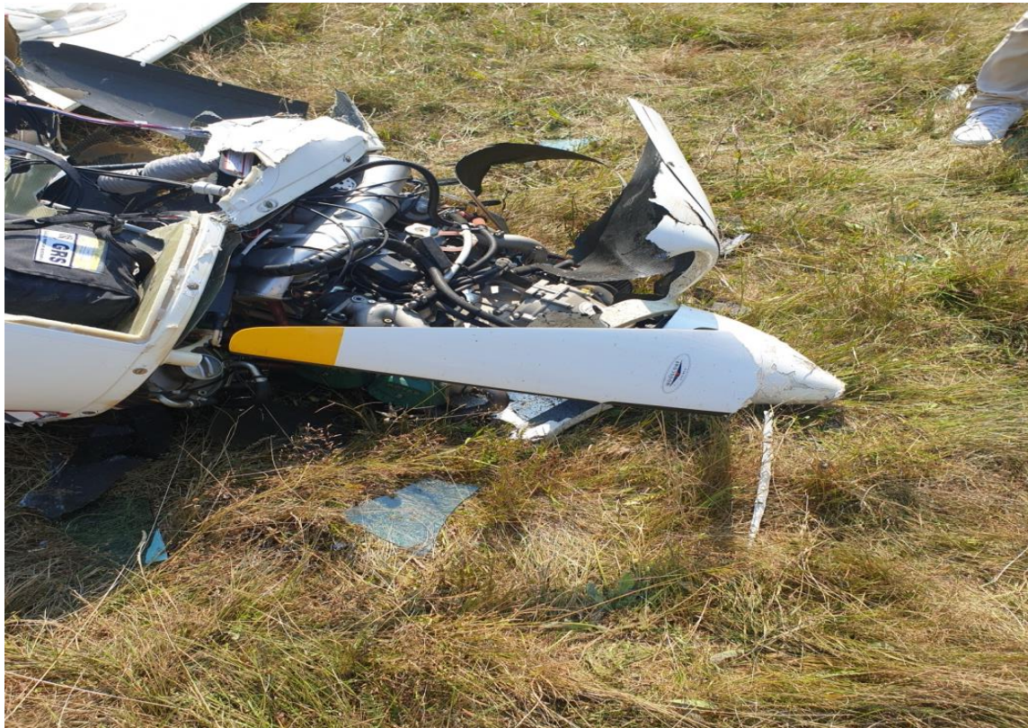
Slika broj 1.11: Nosni dio trupa, motor aviona, glavčina i krak elise nakon udara
