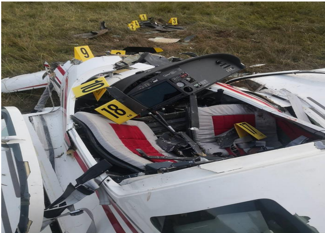
Slika broj 1.14: Kabina aviona i pokidane veze na sjedištu pilota
