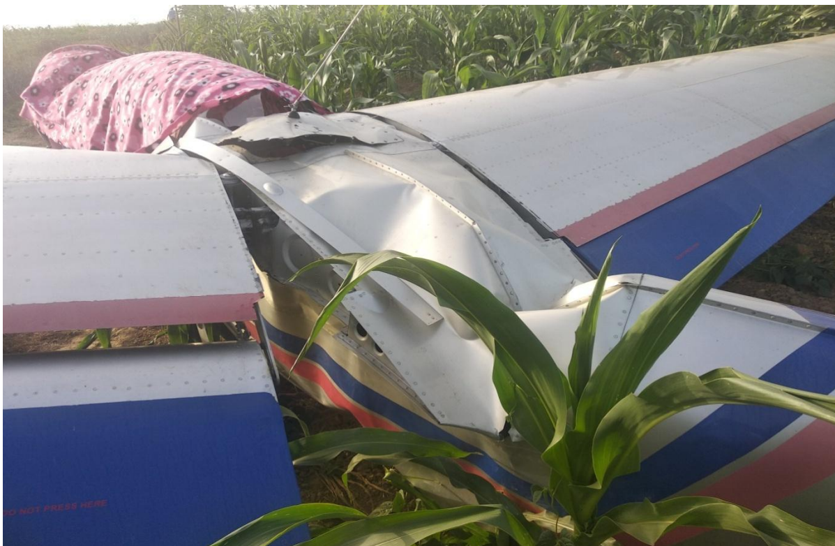
Prilog 5.5: Oštećenje na spoju trup lijevo krilo
