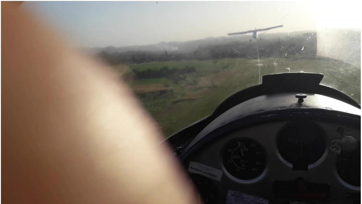
Slika broj 2.2: Početak skretanja nakon pada snage 50 sec. od početka poletanja (1min 12 sec V=100 Km/h, W=+1 m/s, h=10 m)
