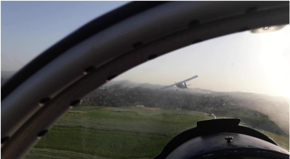
Slika broj 2.3: Trenutak otkaçivanja (01:16, V=50 Kt, H=15-20m), 11 sec prije udara
