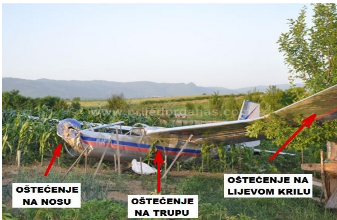
Prilog 5.4: Oštećenje na nosu, trupu i lijevom krilu
