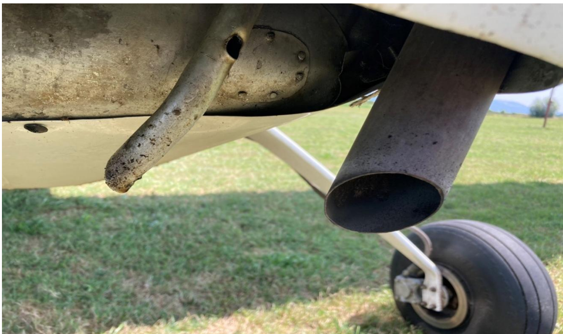
Prilog 5.11: Izduvna cijev - prisustvo crnog depozita i zagaravljenosti
