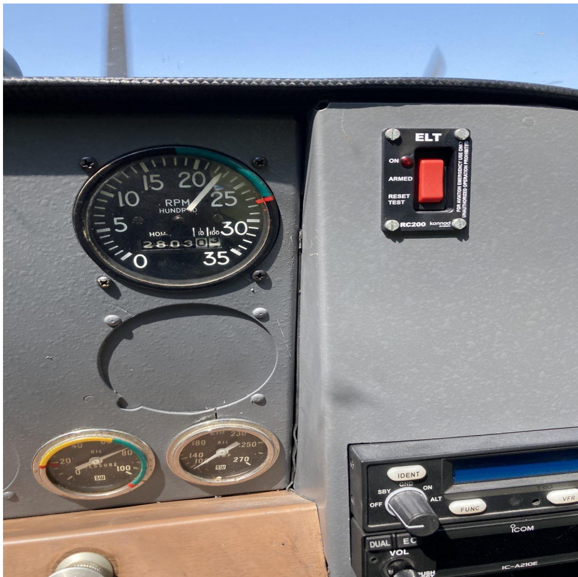
Prilog 5.13. Obrtomjer u kabini - max.broj obrtaja motora Manometar i termometar - Pritisak i temperatura ulja motora
