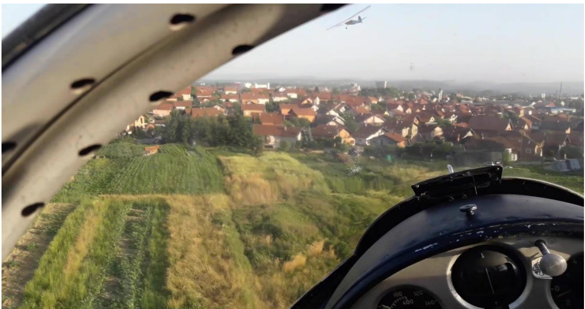
Slika broj 2.4: U 01:19,30 početak reakcije na gubitak vuče aviona zaokretom u lijevo i nos dolje
