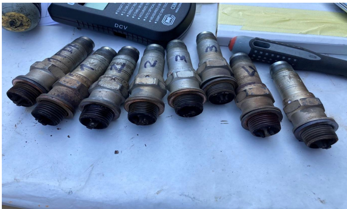
Prilog 5.10: Svječice motora - prisustvo crnog depozita i zagaravljenosti
