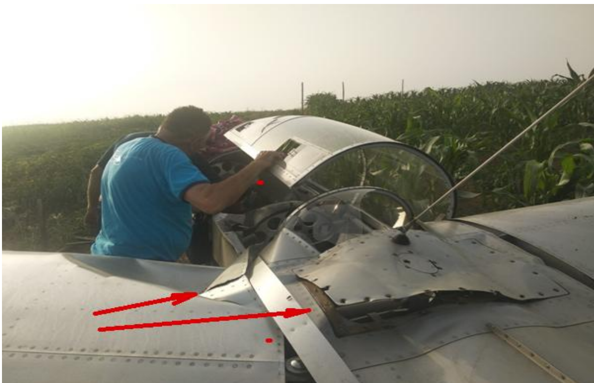
Prilog 5.6: Oštećenje kabine jedrilice i spoja trup-lijevo krilo
